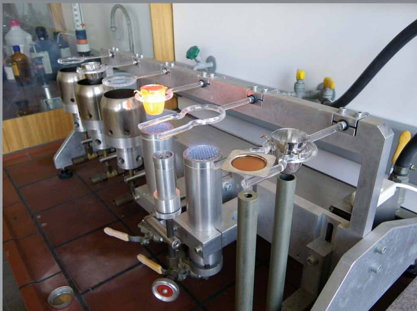
Abb. 81 Brennerkolonne zur Herstellung einer Schmelztablette.
