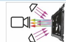
↑ Abbildung 6 (rechts): Infrarot-Reflektographie. Sichtbar werden die Unterzeichnungen des Künstlers, also die Bleistift- oder Pinselstriche, die er auf die Grundierung setzte, bevor die Farbe aufgetragen wurde. Retuschen, erscheinen dunkler als ihre Umgebung da sie die Infrarotstrahlen stärker absorbieren.
